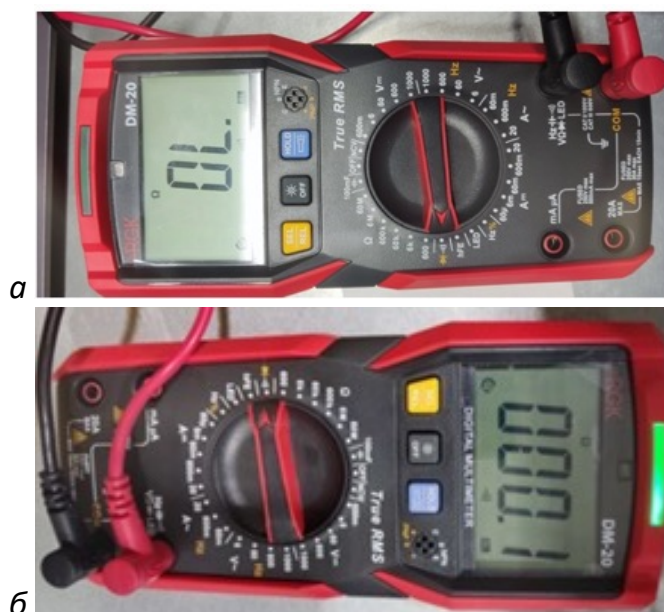
Рис. 4. Результат анализа проводимости электрического тока, где: а – до нанесения, б – после нанесения покрытия
