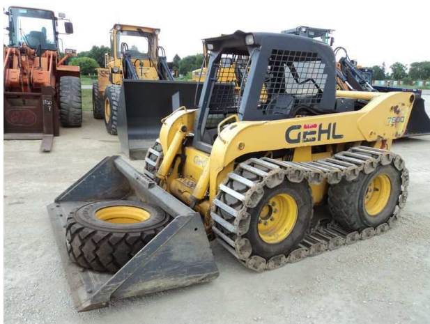
Рис. 2 Колесный погрузчик с резиновыми гусеницами
