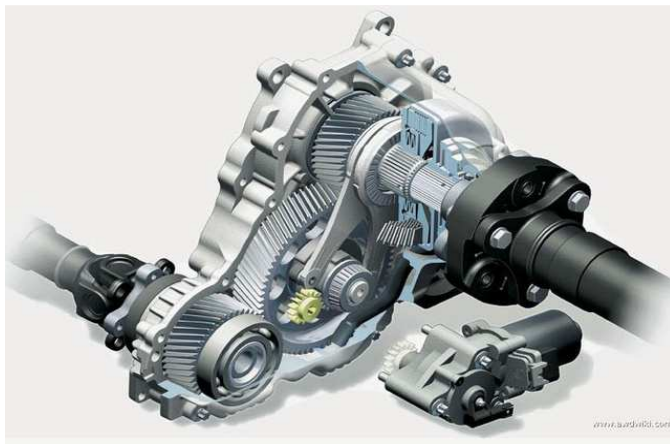
Рис. 3 Схема раздаточной коробки с зубчатой передачей
