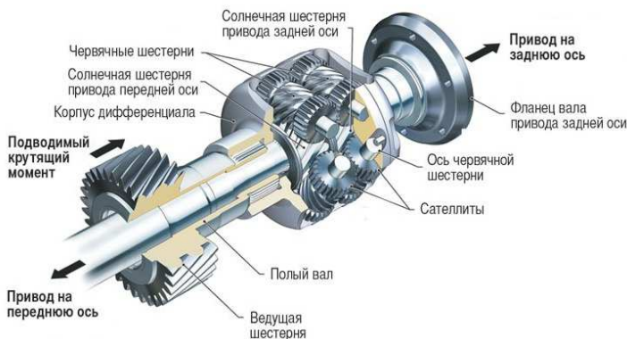
Рис. 2 – Самоблокирующийся дифференциал Torsen
