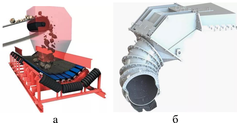
Рис. 2. Устройство пересыпа с конвейера на конвейер: а – классическая схема; б – схема с формирователем потока
