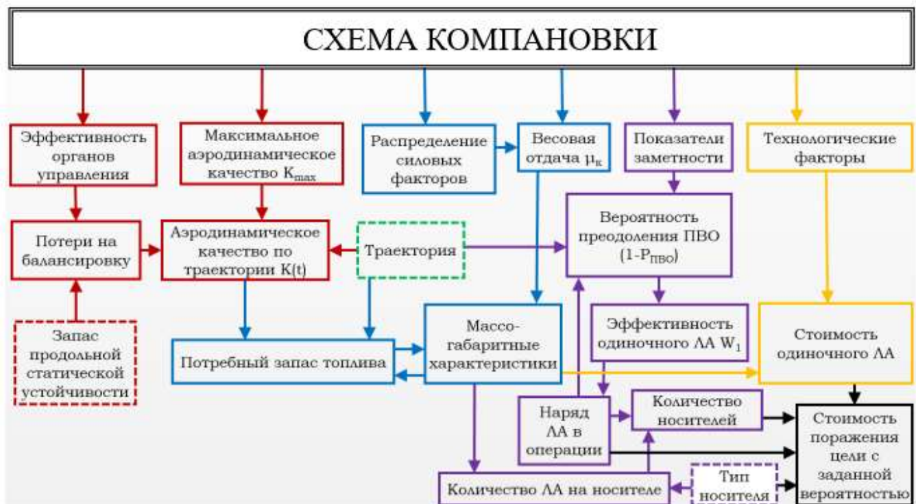
Рис. 1. Схема влияния параметров проекта на компоновку крылатых летательных аппаратов
