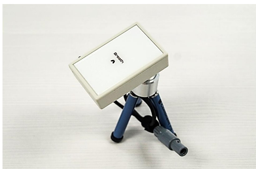
Фото 23. Сенсор механических колебаний грудной клетки
