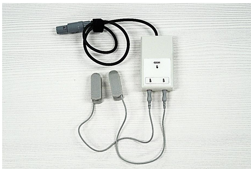
Фото 22. Сенсор кожно-гальванической реакции
