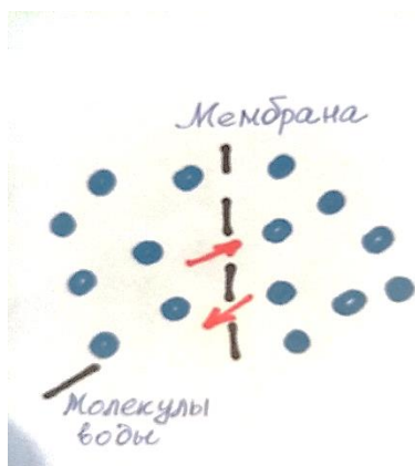
Рис. 7. Прохождение молекул воды через полупроницаемую мембрану.
