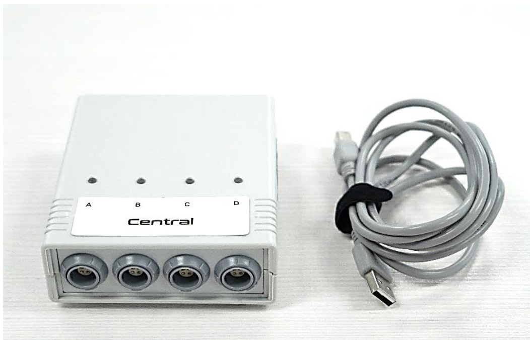
Фото 17. Центральный модуль с кабелем для подключения к ПК
