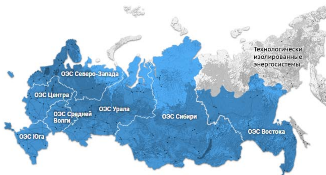
Рис. 1. Карта Единой Энергетической Системы согласно данным АО СО ЕЭС
