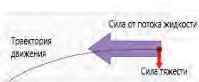
Рис. 1. Силы, действующие на шлам в горизонтальной скважине
