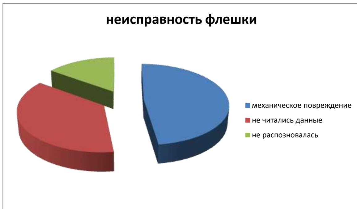
Рис 5. Виды неисправностей флешек
