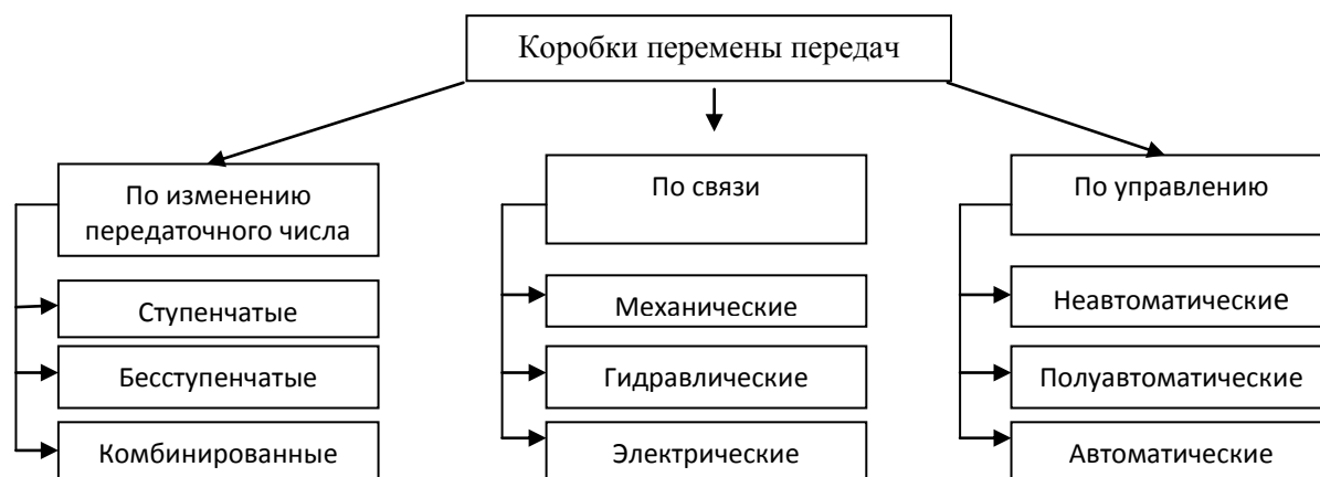
Рисунок 1 – Типы коробок перемены передач, классифицированных по различным признакам
