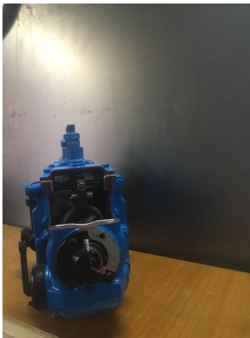
Рисунок 5 – Стенд с разрезом, демонстрирующим систему смазки подшипника
