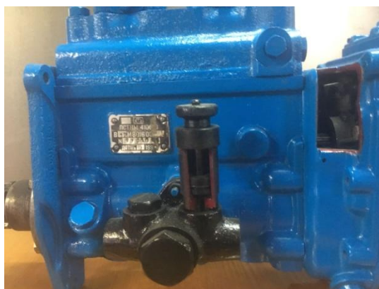
Рисунок 4 – Стенд с разрезом, демонстрирующим помпу подкачки топлива
